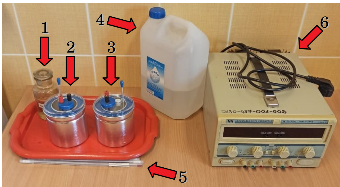
Rysunek 1: Aparatura pomiarowa: badana ciecz (1), kalorymetry (2), (3), woda destylowana (4), termometry (5), zasilacz prądu stałego (6). Ponadto: waga, stoper
