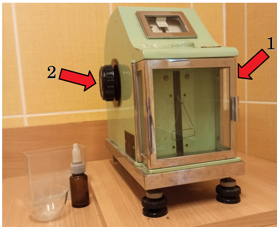
Rysunek 1: Waga torsyjna. Ponadto: statyw, naczynie z roztworem mydła, ramki, suwmiarka
