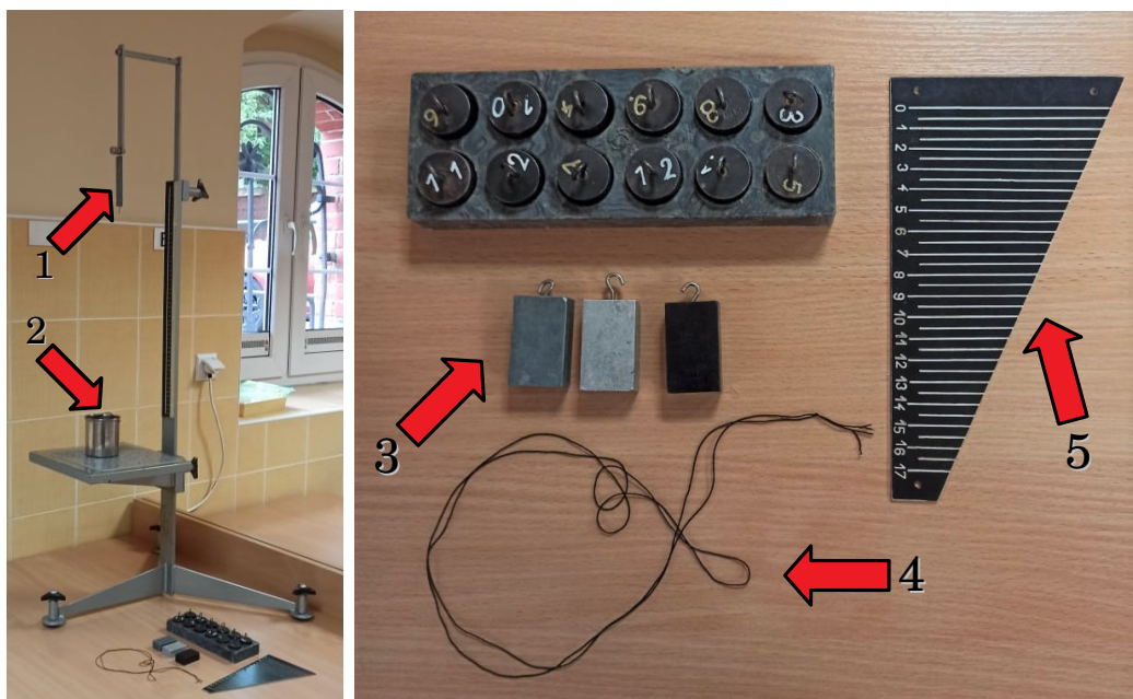
Rysunek 1: Schemat aparatury: sprężyna (1), pojemnik z wodą destylowaną (2), zestaw odważników (3), gumki (4), przymiar (5)
