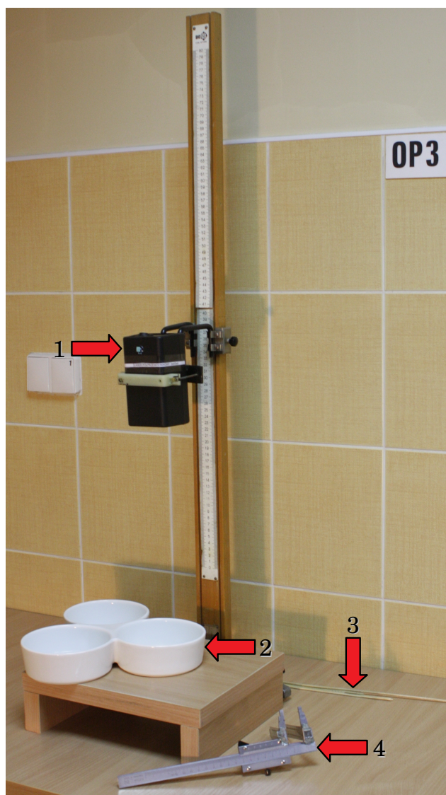
Rysunek 2: Aparatura pomiarowa: laser półprzewodnikowy (650 nm) (1), cylindryczne naczynia o białym dnie (2), drewniane patyczki do określenie głębokości cieczy w naczyniu (3), suwmiarka z wąsami do pomiaru średnicy nieoświetlonego krążka (4)
